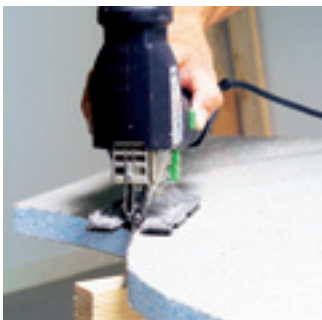
8. Sahaa pohjalevystä pistosahalla piirtämäsi ympyrä. Jos et tarvitse LUX-levyä lattiaksi tai katoksi, niin voit käyttää jotakin muuta levyateriaalia.
